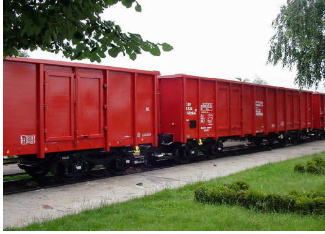
Resim 1.20: 4 Dingilli yerden tahliye flaplı vagon (TİP Eads)
