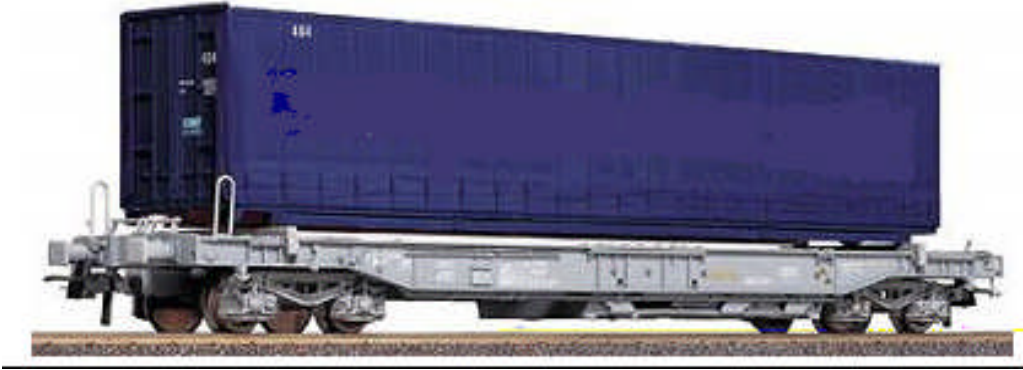
Resim 1.17: Konteyner vagonu (TİP Smmgs)
