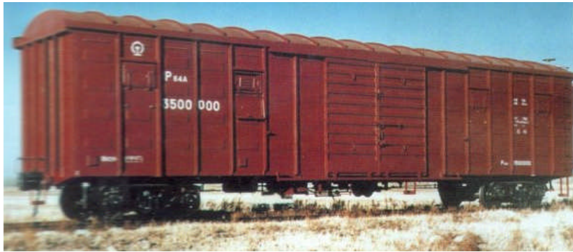
Resim 1.21: 4 Dingilli kapalı kasa vagon (TİP Gabs)
