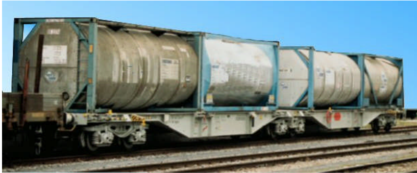
Resim 1.22: 4 Dingilli konteyner vagonu (TİP Sgmmrss90)
