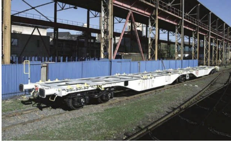
Resim 1.23: 4 Dingilli konteyner vagonu (TİP Sgmmrss90)
