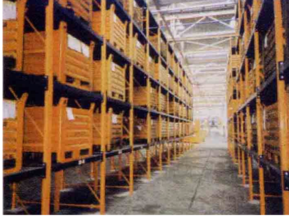
Resim 1.6: Tek paletli raf sistemleri
