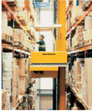
Resim 2.6: Dar koridor istif makinesi
