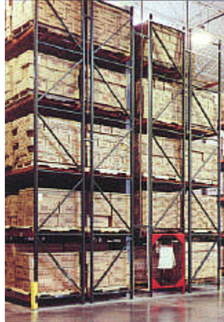
Resim 1.5: İki derinlikli (double deep) depolama sistemleri
