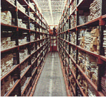
Resim 1.12: Dar koridorlu depolama sistemleri
