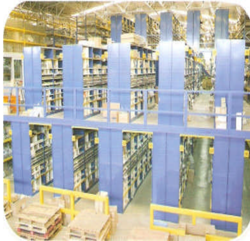
Resim 1.15: Mezanin tip raf sistemleri
