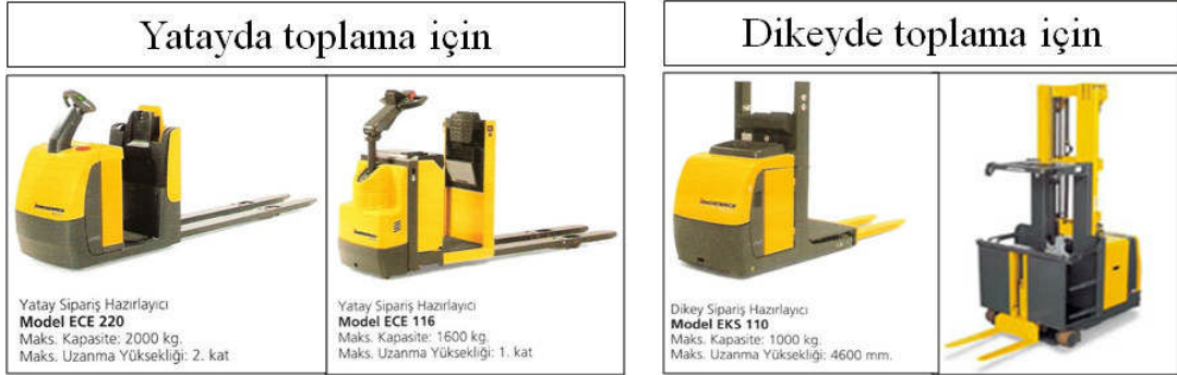
Resim 2.7: Yatayda ve dikeyde sipariş toplama araçları
