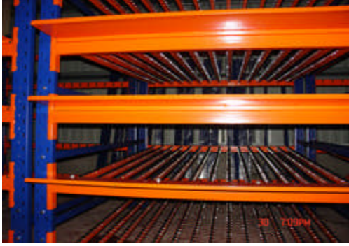
Resim 1.9: Kayar raf sistemleri
