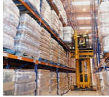
Resim 1.12: Dar koridorlu depolama sistemleri
