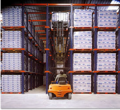
Resim 1.7: İine girilebilir raf sistemleri
