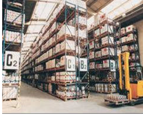
Resim 1.4: Sırt sırta (back to back) depolama sistemleri
