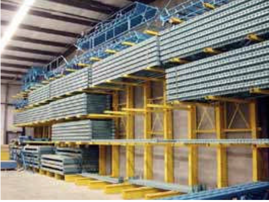
Resim 1.18: Konsollu tip raf sistemleri
