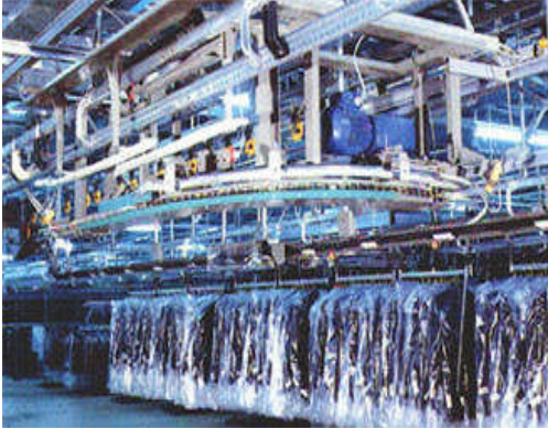
Resim 1.13: Askılı konveyör depo sistemleri
