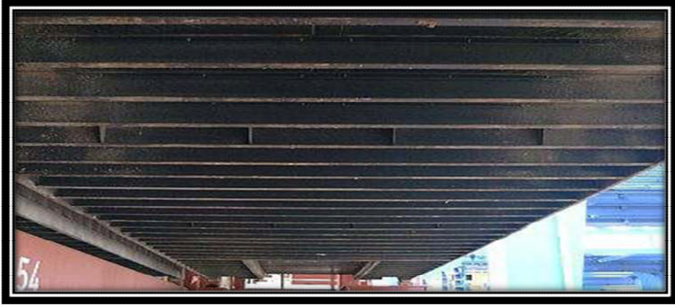
Resim 2.7: Konteyner taban döşemesi ve profili
