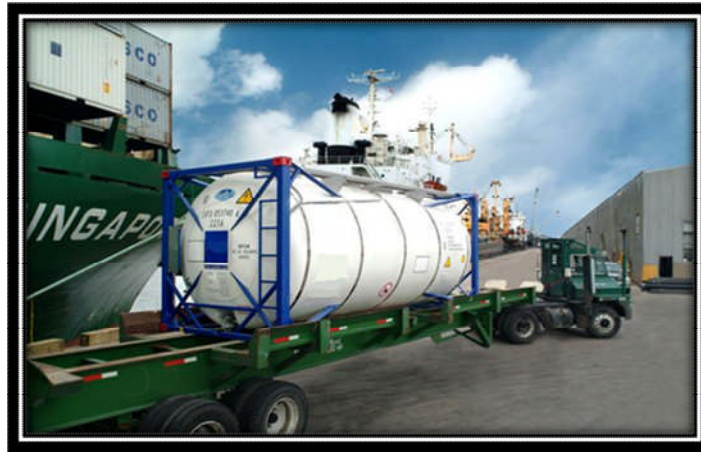
Resim 2.39: Tank konteynerin nakliyesi
