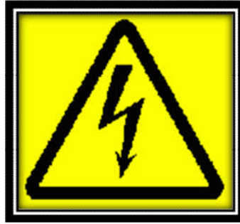
Resim 2.72: Havai elektrik ikaz işareti
