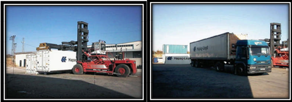
Resim 2.35: Soğutmalı konteynerin yüklenmesi ve taşınması
